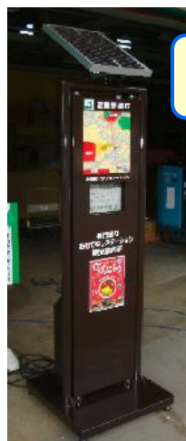
防災情報システム 避難誘導灯
